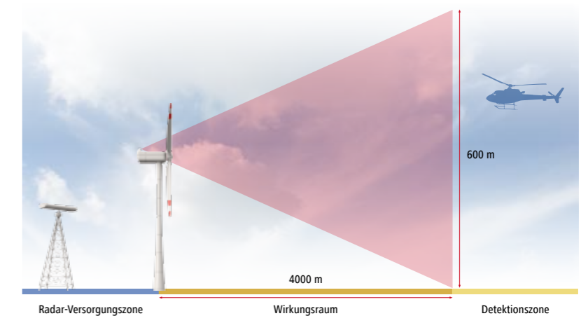
Aktivierung der Befeuerung bei Eintritt eines Flugobjektes in den Wirkungsraum des Detektorsystems
